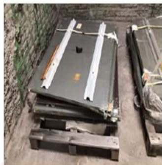
1. 投料前準備 (拆框架及電線，去除髒污及雜物)
